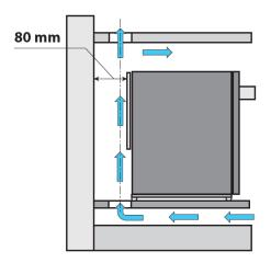
Der Kühlschubladenkühlschrank muss in eine Möbelnische von mindestens 200 cm<sup>2</sup> eingebaut werden ermöglicht die Luftzirkulation innen und außen.
