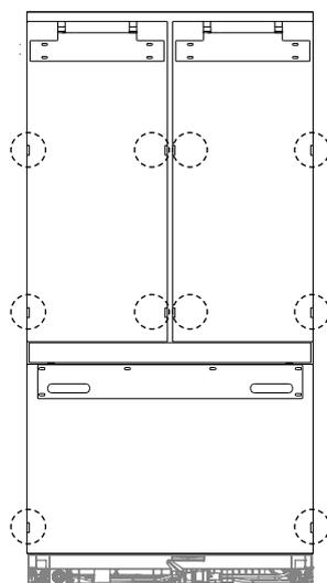
Schrauben Sie die Kreuzschlitzschrauben M5x10 locker in die Türen (1-2 Umdrehungen).
