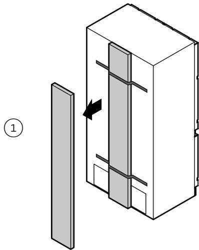
Entfernen Sie das Verkleidungsset von der Hinterseite des Geräts. Im Abschnitt „Installationsset Verkleidung (große Schachtel)“ finden Sie eine Liste der mitgelieferten Einzelteile.
