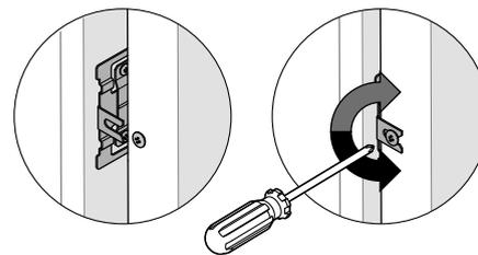
Schieben Sie die Aussparungen der seitlichen Klammern auf die Schrauben an der Tür.
