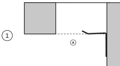
Gehen Sie von der Unterkante der Montagenische aus horizontal zur Mitte der Hinterwand (**A**). Dadurch ist gewährleistet, dass sich die Kontaktfläche zwischen Klammer und Gerät befindet.
