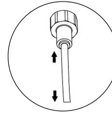
Stecken Sie das freie Ende des Kunststoffschlauchs vollständig in den Wasserhahnadapter. Ziehen Sie leicht am Schlauch, um sicherzustellen, dass er fest sitzt.
