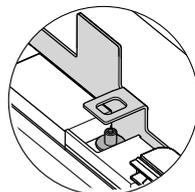
Öffnen Sie die Tür und lösen Sie die Kreuzschlitzschrauben M5x10 an den Seiten der Türen (Schrauben nicht entfernen).
