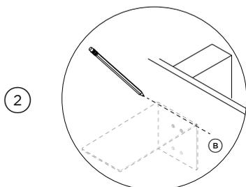
Ziehen Sie an der Hinterwand eine horizontale Linie (**B**).
