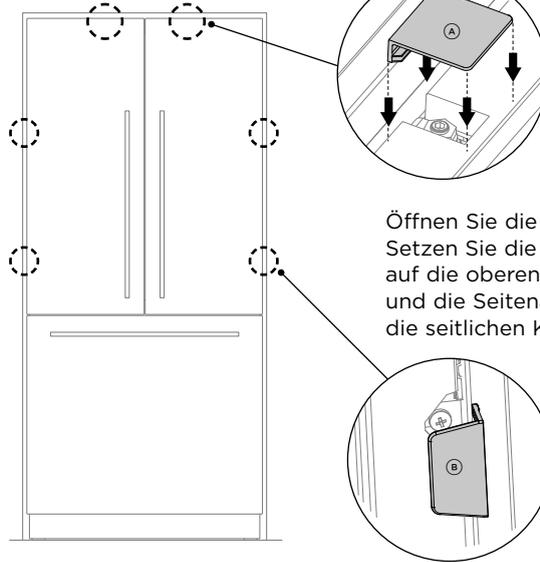
Öffnen Sie die Glastüren. Setzen Sie die oberen Abdeckungen auf die oberen Halterungen und die Seitenabdeckungen auf die seitlichen Klammern.
