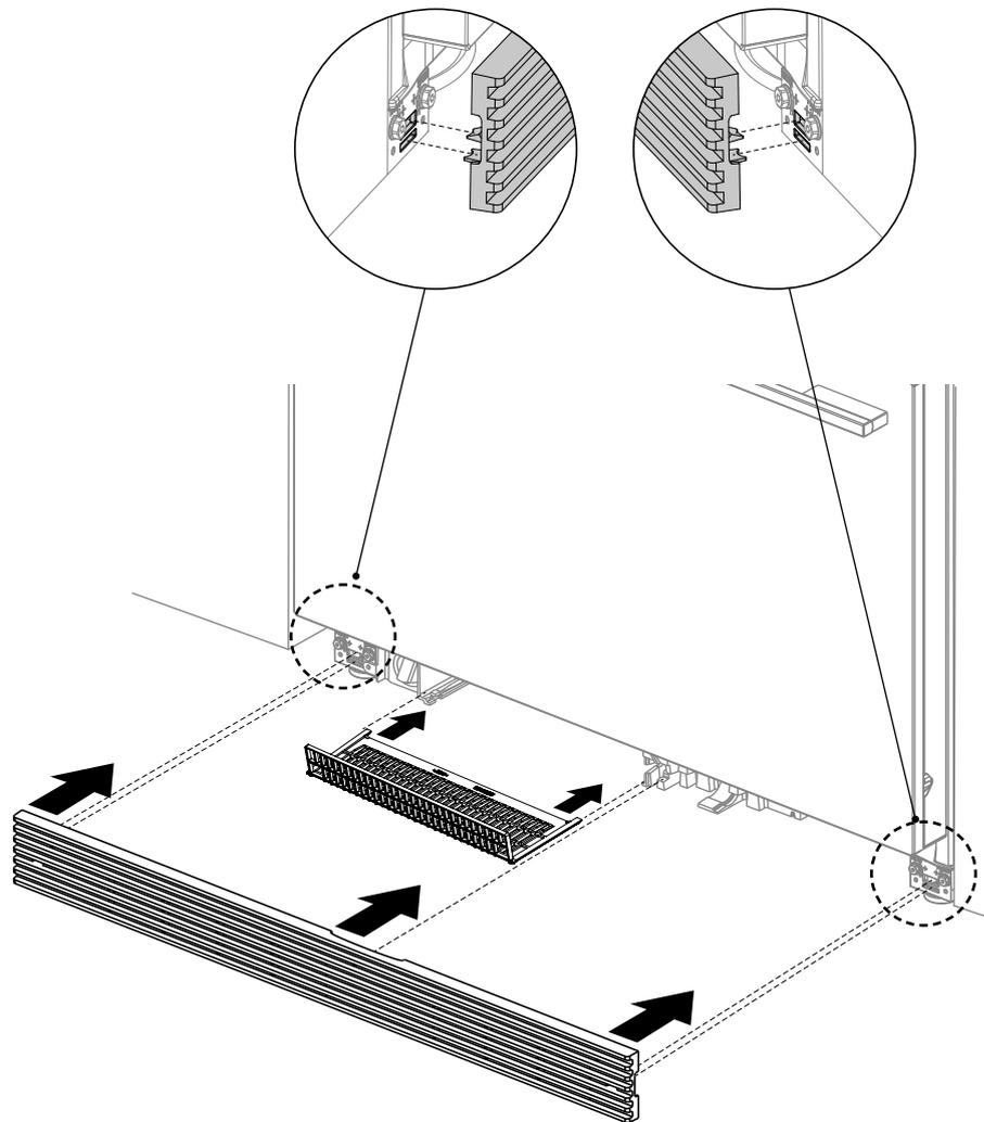
Stecken Sie den Filter auf die Schienen und schieben Sie ihn weiter, bis er einrastet.
