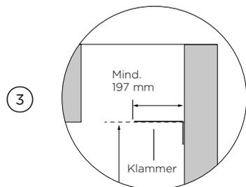
Drücken Sie die Klammer an die Hinterwand. Setzen Sie die Unterseite der Klammer auf die markierte Linie.
