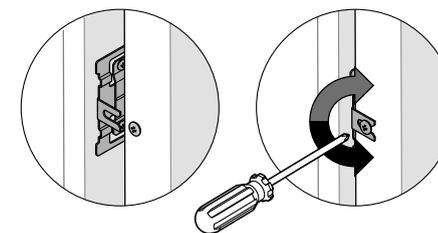
Schieben Sie die Aussparungen der seitlichen Klammern auf die Schrauben an der Tür. Ziehen Sie die Schrauben leicht an, um die Türverkleidung zu sichern.
