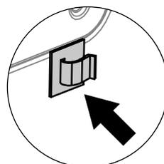
Bringen Sie hinter dem Gerät eine Klammer zur Befestigung des Stromkabels an **(B)**.
