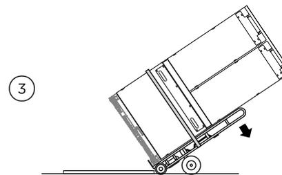
Befestigen Sie das Gerät mit Riemen an der Sackkarre.
