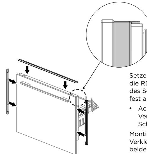
Setzen Sie die Verkleidung an die Rückseite der Verkleidung des Schubfachs und drücken Sie sie fest an.
