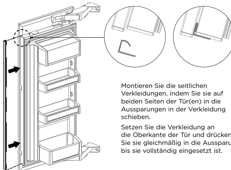
Montieren Sie die seitlichen Verkleidungen, indem Sie sie auf beiden Seiten der Tür(en) in die Aussparungen in der Verkleidung schieben.
