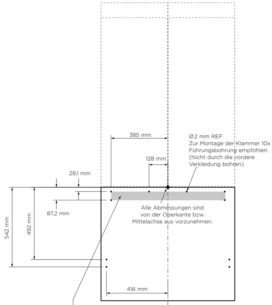
Durchbrüche befinden sich nur in den Befestigungsklammern der Griffe von Fisher & Paykel. Wenn Sie in der grau unterlegten Fläche einen maßgeschneiderten Griff anbringen möchten, achten Sie darauf, dass die Schraubenköpfe an der Rückseite der Verkleidung versenkt sind, um Überschneidungen mit der Befestigungsklammer zu vermeiden.
