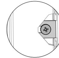
Befestigen Sie die Seitenklammern, indem Sie die Schrauben in den Aussparungen festziehen. Wiederholen Sie den Vorgang an allen Verkleidungen.
