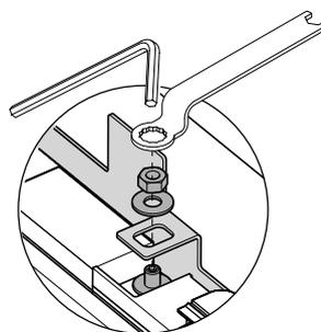
Schrauben Sie die Unterlegscheibe und Mutter M8 mithilfe des Inbusschlüssels und Spanners lose auf die Halterung.
