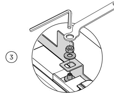
Schrauben Sie die Unterlegscheibe und Mutter M8 mithilfe des Inbusschlüssels und Spanners lose auf die Halterung.
