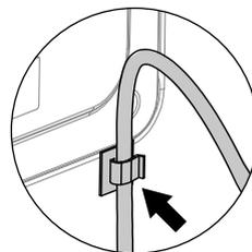
Wenn das Stromkabel zu lang ist, können Sie es an der Klammer befestigen.
