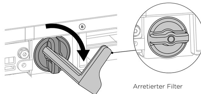
Setzen Sie das Werkzeug zum Entfernen des Filters auf den Filtergriff und befestigen Sie ihn, indem Sie es 90° im Uhrzeigersinn drehen. Entfernen Sie das Werkzeug zum Entfernen des Filters und schließen Sie das Schubfach des Gefrierfachs.
