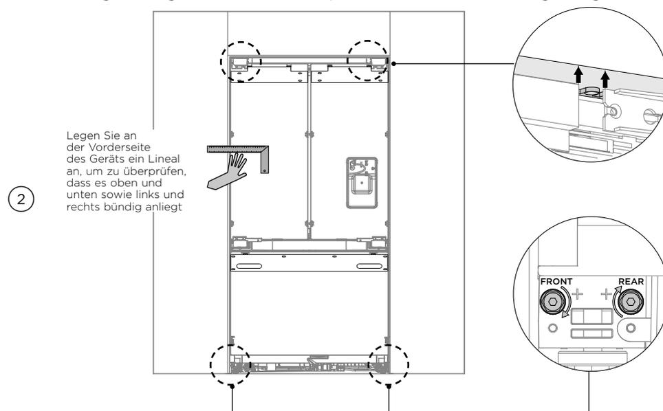
Legen Sie an der Vorderseite des Geräts ein Lineal an, um zu überprüfen, dass es oben und unten sowie links und rechts bündig anliegt
