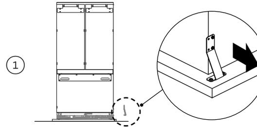
Entfernen Sie die Klammern an einer Seite des Geräts. (Bei Modellen mit nur einer Tür entfernen Sie die Klammern an der Seite ohne Scharnier.)
