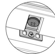
Lösen Sie die Kreuzschlitzschraube M8x16, um die Arretierklammer frei verschieben zu können.
