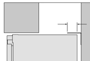
Wenn Sie das Gerät in die Montagenische schieben, achten Sie darauf, dass die Kippschutzklammer über die Rückseite des Geräts greift.
