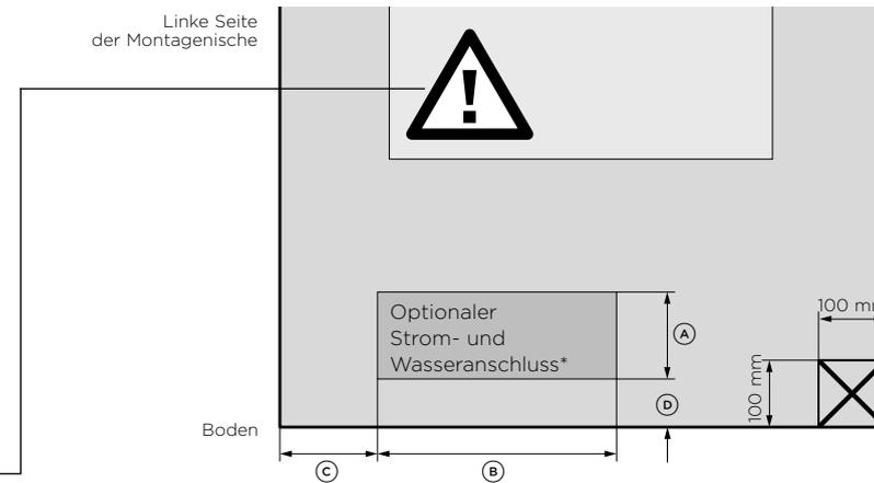
Strom- und Wasseranschluss müssen sich bei Anschluss hinter dem Gerät innerhalb dieses Bereichs befinden und dürfen nicht von der Hinterwand vorstehen.
