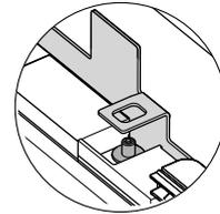
Öffnen Sie die Tür und lösen Sie die Kreuzschlitzschrauben M5x10 an den Seiten der Türen (Schrauben nicht entfernen).
