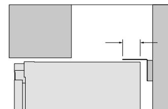
Sollte ein Überstand von mindestens 180 mm nicht möglich sein, montieren Sie am Träger hinter der Klammer einen Abstandhalter.
