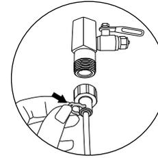
Sichern Sie den Anschluss zwischen Wasserhahnadapter und Verschlussklemme mit einem Arretierring.
