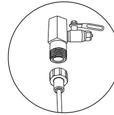
Schließen Sie den Wasserhahnadapter an einen Wasserhahn an. Lassen Sie vor der Verbindung mit dem Gerät Wasser durch den Schlauch fließen, um etwaige Rückstände zu entfernen.
