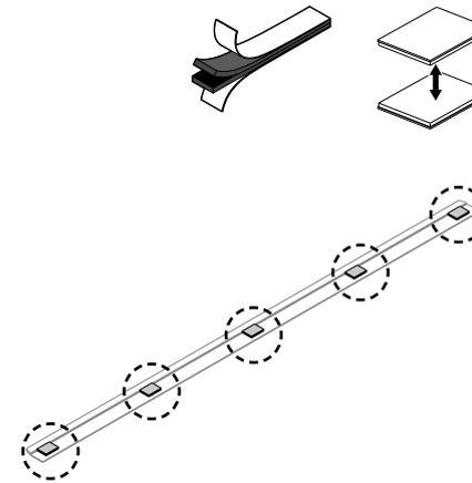
Ziehen Sie von zwei Stück des zweiseitigen Klebebands die Folie ab und drücken Sie sie aneinander.
